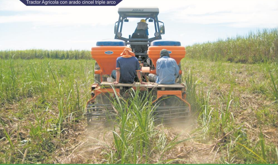
Tractor Agrícola con fumigadora y capacidad de 3500 litros
